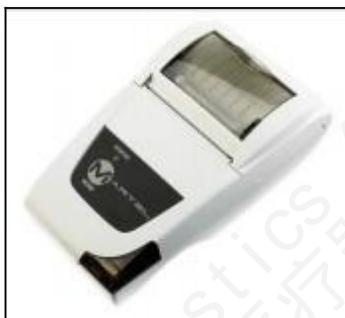
测量结果可用热敏打印机MCP1880打印。打印功能在打印菜单中被激活。参见Section6.9.2，第21页。
