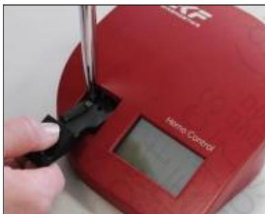
打开比色片托盒，直到你感到阻力。用圆珠笔按下托盒左侧的锁闩，同时将比色片托盒向后拉。
