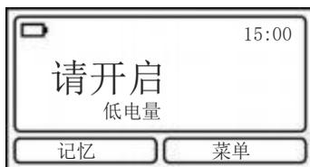
电池符号表示其剩余电量。该设备在低电量时显示“电量不足”的警告。如果电池没有充电，一段时间后设备就会关闭。
