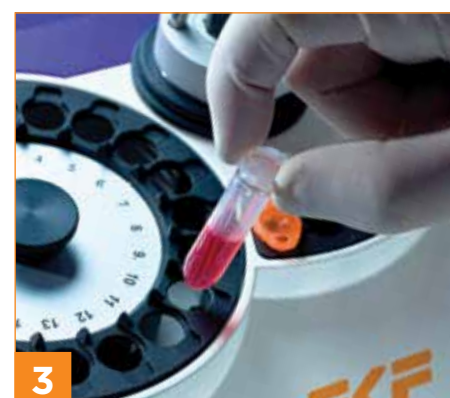
将毛细管放入反应管中并倒置直至混合。20至45秒产生结果。
